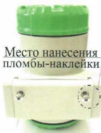
Рисунок 2 – Схема пломбировки от несанкционированного доступа
